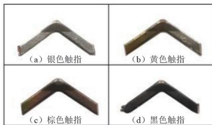
图 2 触指片 4 类腐蚀形态
