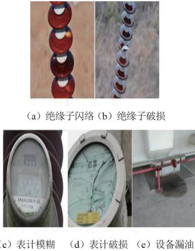
(a) 绝缘子闪络 (b) 绝缘子破损
