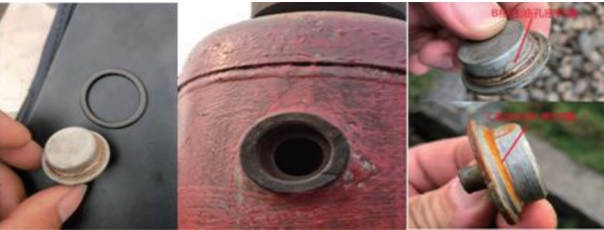
图 9 停电检查确认密封缺陷
