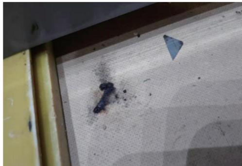
图 3 三角形硅钢片烧蚀痕迹
