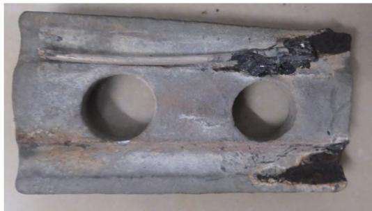
图 2 500 kV 地线并沟线夹腐蚀故障
