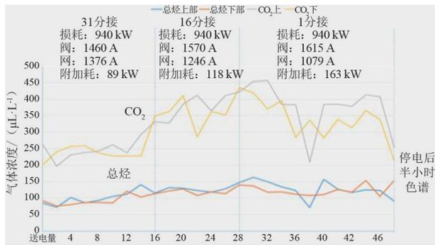
图 2 过电流试验期间本体色谱变化曲线
