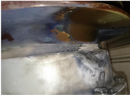
图 4 103 电流互感器底座放电痕迹
