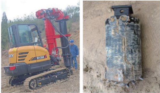
(a) 山地模块化微型钻机施工场景 (b) 施工时所使用的体开斗钻具
