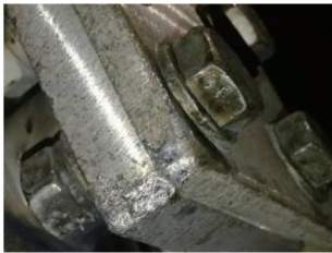
图 6 103 电流互感器 P2 端放电痕迹
