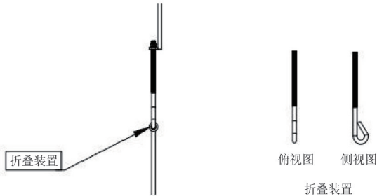
图 5 固定架折叠装置
