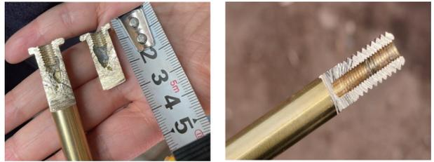
图 7 导杆烧蚀螺孔行纵向切剖
