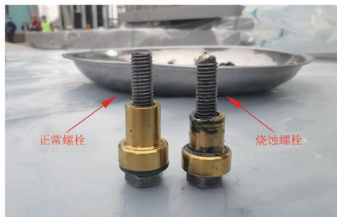
(c) 正常螺栓与烧蚀螺栓比较
