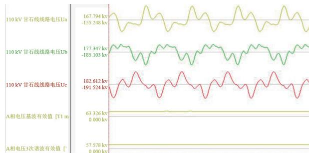
图2 谐波过电压实际波形
