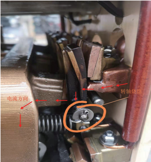
图 3 主动触头过热发黑现象
