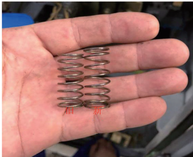
图 4 分闸铁芯复位弹簧
