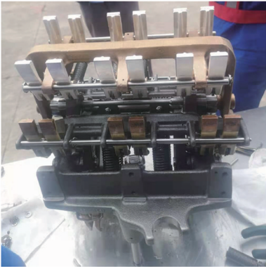
图 5 修复后的触头组
