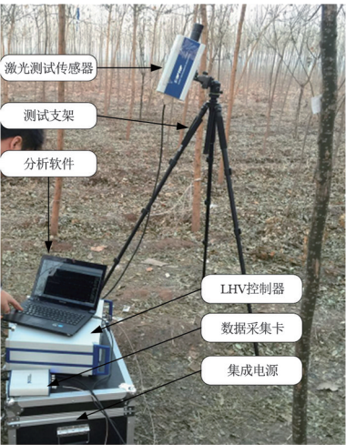
(a) 测试设备安装
