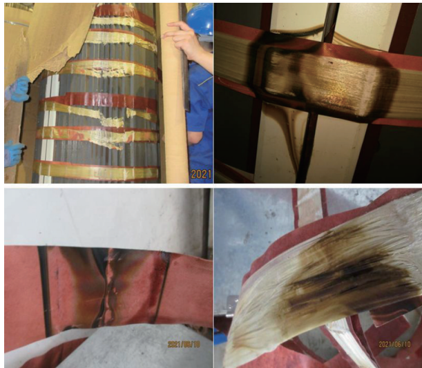
图 4 多处拉板、无纬带、绝缘纸板发黑
