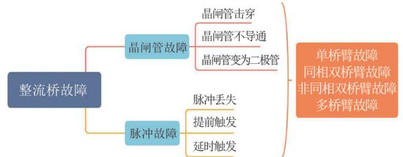
图 2 三相全控可控硅整流桥的故障类型
