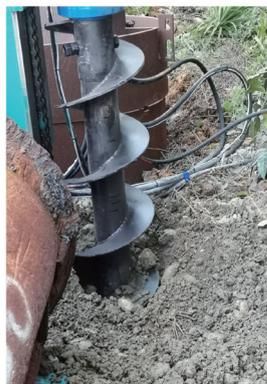
图 7 微型桩钻机实地钻进试验
