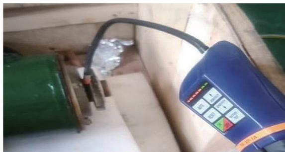
图 2 利用  $SF_6$  检漏仪检查套管漏气情况
