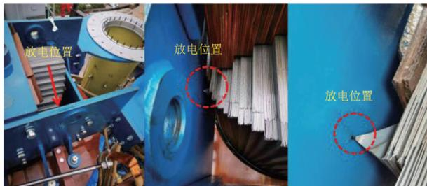
图 15 变压器解体检查结果
