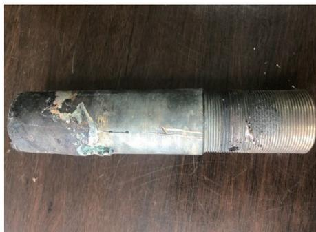
图 3 C 相套管将军帽处导体螺纹熔化痕迹
