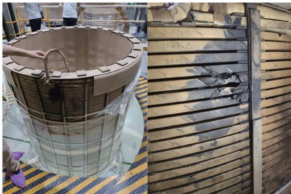
图 5 A 相高压绕组匝间短路
