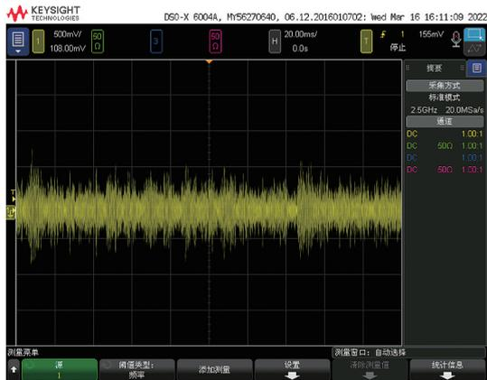
图7 某变压器运行期间振动产生的超声波信号
