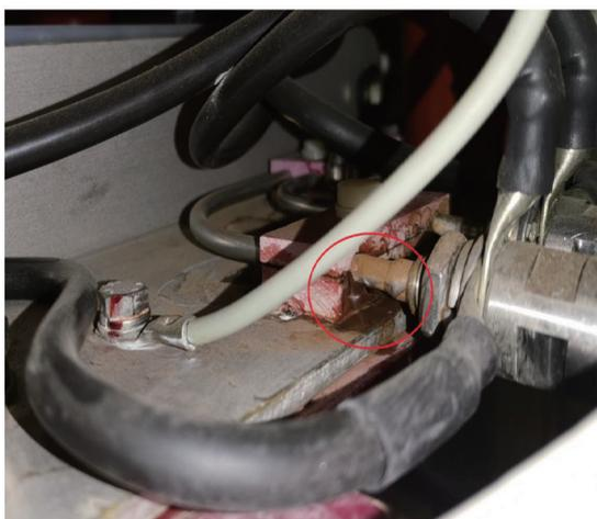
图4 水管与压板振动磨损缺陷
