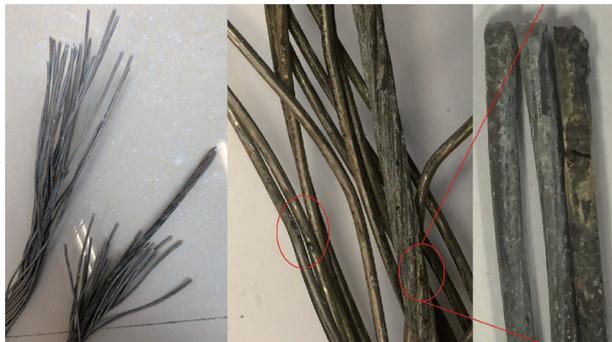
图1 断裂导线形貌
