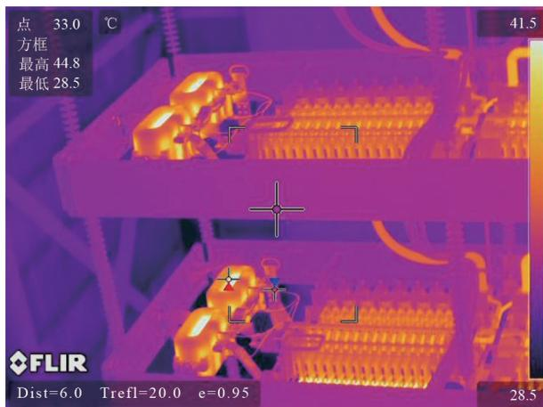
图9 新型饱和电抗器运行红外图谱
