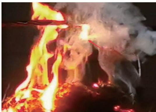
图 3 导线与铁丝 3 cm 间隙被击穿造成单相接地
