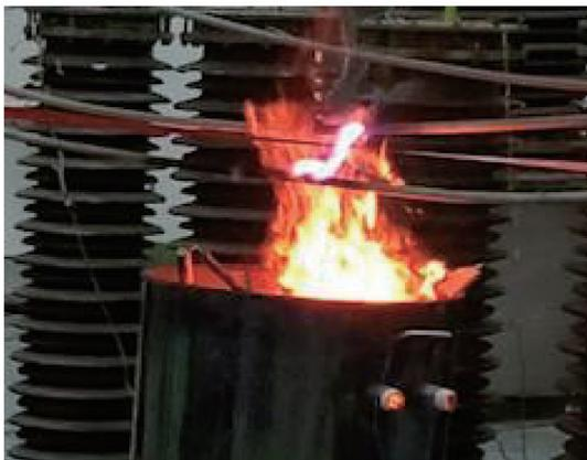
图 6 火焰相间导线试验
