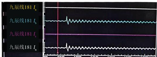
图 2 181 断路器电流故障录波
