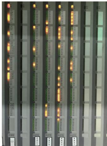
图 3 经几何定位与区域选择得到的指示灯亮、灭结果
