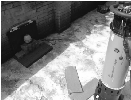
图 9 支撑绝缘子现场 X 射线成像检测
