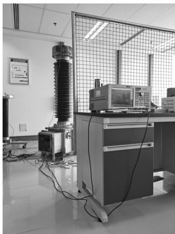
图4 AGILENT E5071C 对 CVT 的测量
