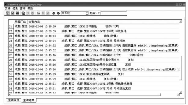
图 5 繁江站接地故障后执行及状态反馈过程
