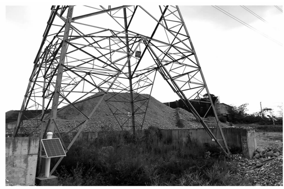
图 3 基于塔基沉降的地质灾害监测装置
