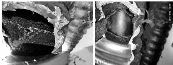
图6 电缆铝护套开窗检查
