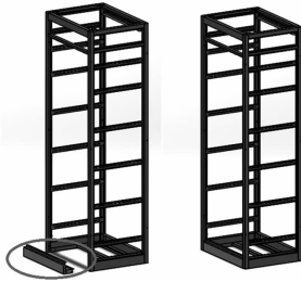
图 2 屏柜后下横梁拆卸
