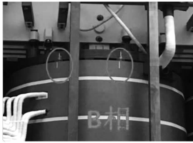
(a) 短路试验后划线错位
