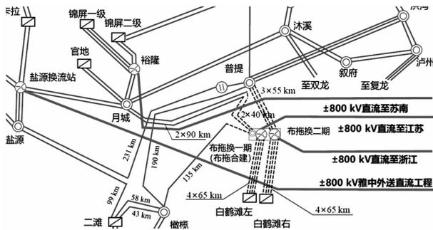
图1 金沙江二期特高压直流送端换流站接入系统方案
