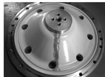
图 8 B 相盆式绝缘子放电痕迹 (耐压试验时放电击穿)
