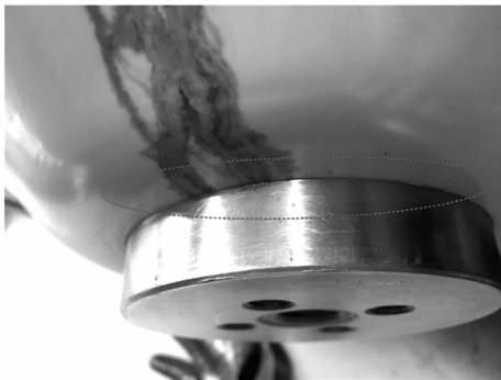
图 9 放电盆式绝缘子与金属嵌件交界情况 (耐压试验时放电击穿)
