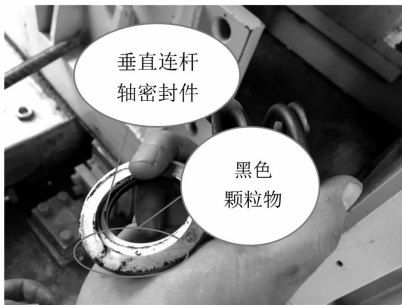
图 5 断路器垂直连杆轴密封件上的颗粒物
