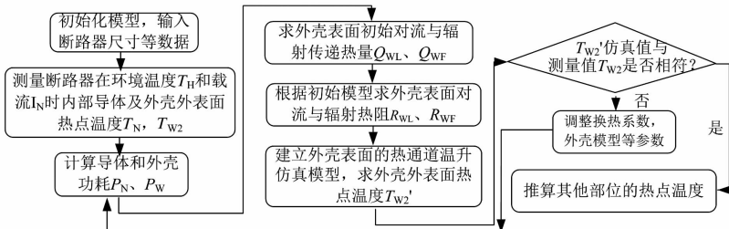
图 4 EM 断路器外壳外表面温升计算过程
