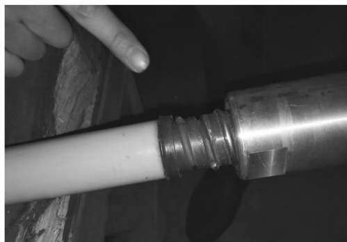
图3 绝缘拉杆下部与金属拉杆的螺纹连接处弹簧退丝情况
