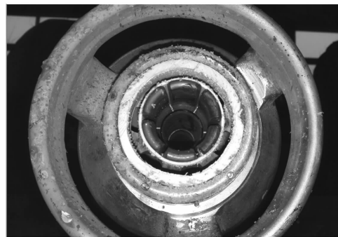
图6 动弧触头瓣明显胀大情况
