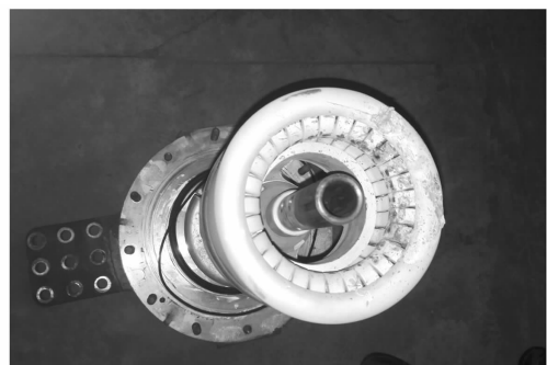
图4 静主触头及屏蔽罩烧灼情况
