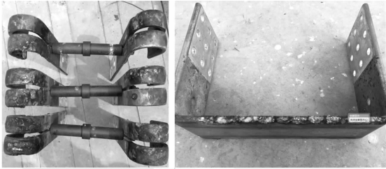
图 1 隔离开关触头烧蚀情况
