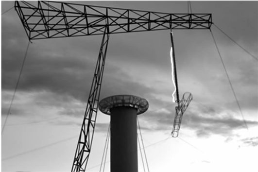
图 9 高海拔地区边相绝缘子串雷电冲击放电
