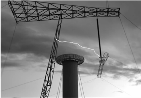
图 7 高海拔地区边相导线 - 塔身操作冲击放电
