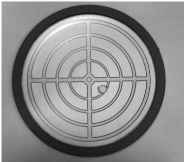
图 6 被损坏的晶闸管芯片
