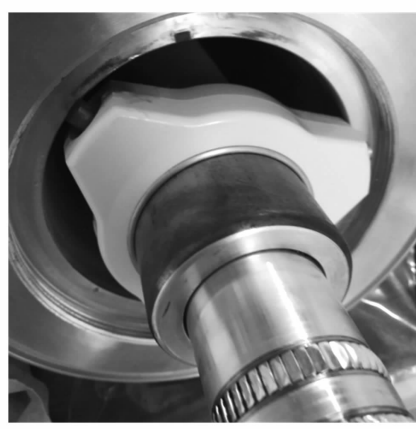
图 5 现场绝缘子局部放电痕迹
