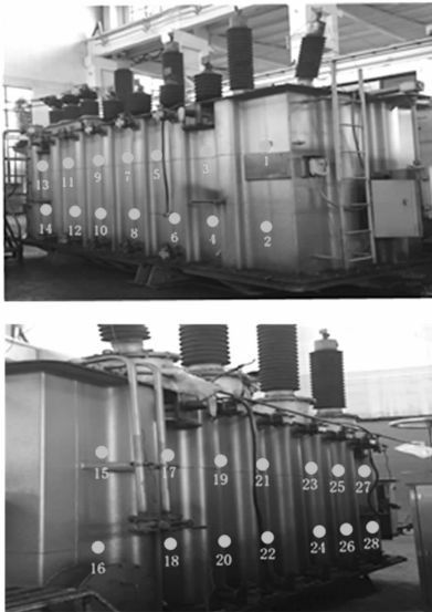
图 4 变压器的测点分布
