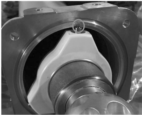
图9 支撑螺钉末端弹簧位置图
