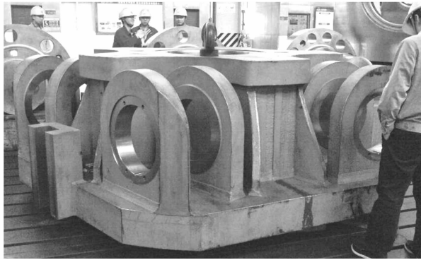
图4 葛洲坝小机改造后操作架
