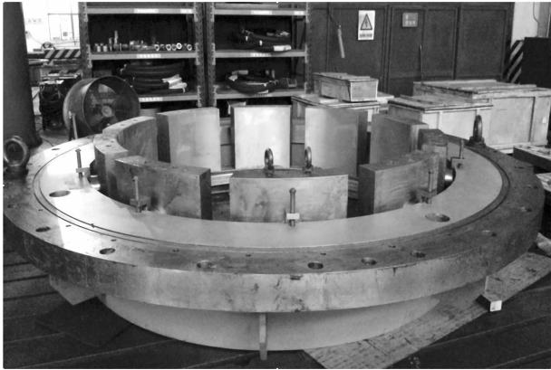
图8 改造后轴承装配在厂内预装
