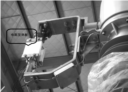
图 3 触头过热故障模拟装置
