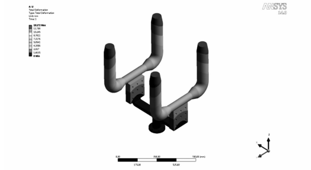
图 5 “U”型结构整体变形云图
