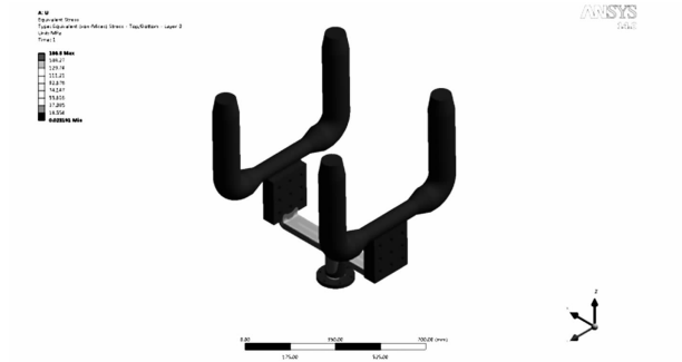
图 6 “U”型结构整体应力云图
