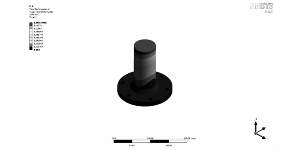
图 12 接线柱变形云图(“一”字型)
