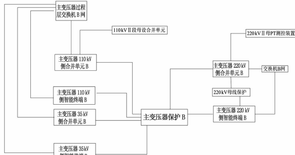
图 2 主变压器 B 套保护相关信号流向
