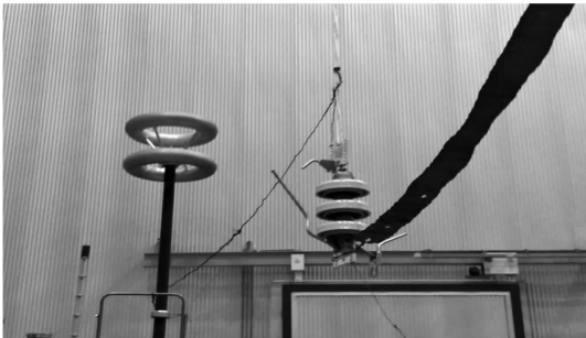
图 5 招弧角击穿试验形
