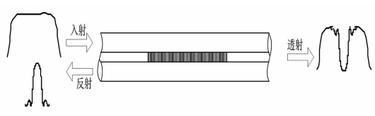
图1 光纤传感器的原理结构图
