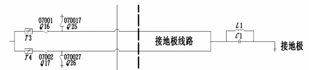
图 8 宜宾站接地极线路电流互感器配置图 针对单极大地回线方式下故障类型的特点,提出基于纵联差动保护 [6] 与横联差动保护原理相结合的接地极故障判别方法,即在接地极引线的近站端和极址端均安装电流互感器。如图 9 所示,采集
