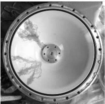
图 7 50212 隔离开关盆式绝缘子沿面闪络
