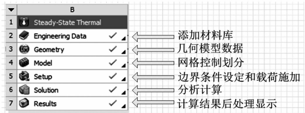
图 2 ANSYS – Workbench 项目流程图
