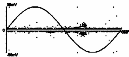
图 6 GIS 导体毛刺产生的超声波相位聚集图谱
