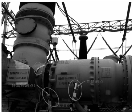
图 9 超声波传感器和特高频传感器布置
