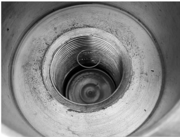
a) 将军帽螺牙处过热烧损
