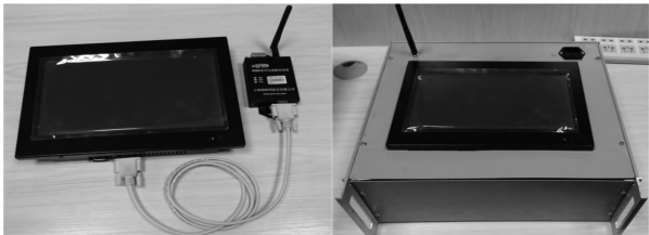
图 6 上位机与无线设备的封装
