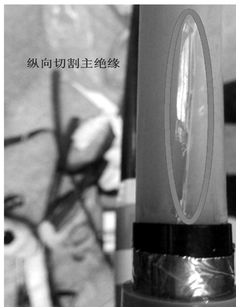
图 8 主绝缘割伤(纵向切割)
