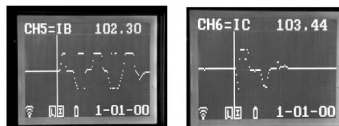
图3 斑肖线B、C相故障电流波形图
