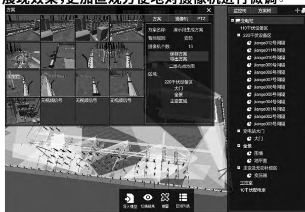
图 2 摄像机安装方案实景展示图
