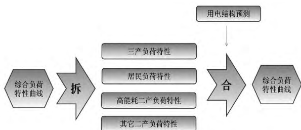
图 3 基于行业负荷曲线重构的日负荷特性预测流程
