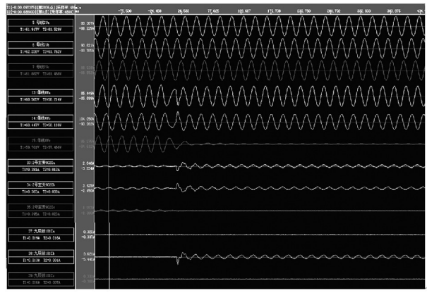
图 3 故障开始时的录波图
