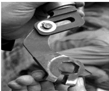
图 6 动触头传动轴件磨损情况
