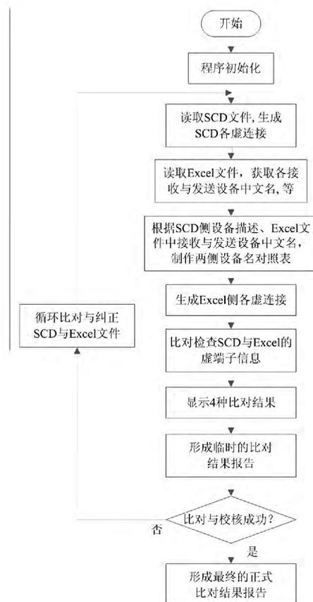
图1 SCD智能比对软件的流程图
