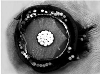
图 2 故障电缆横切面分布
