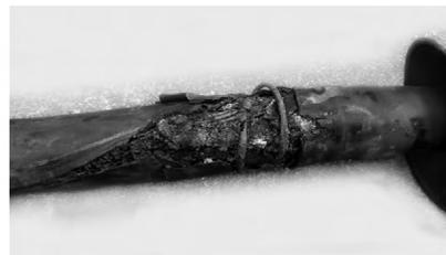
图1 电缆绝缘老化击穿部位(铜辫接地处)
