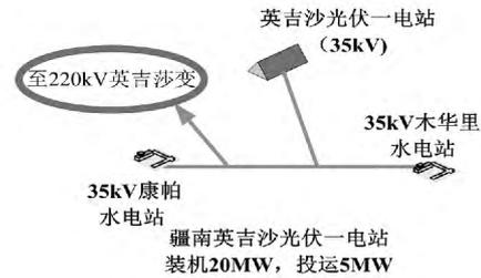
图2 光伏一电站“T”型接线图
