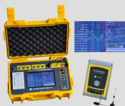
GDYZ-301 氧化锌避雷器测试仪
