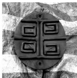
图 4 防水盖没有涂密封胶
