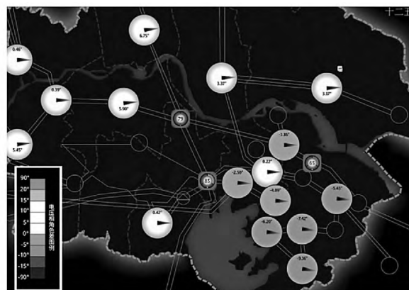
图 3 全网电压相角分布可视化效果
