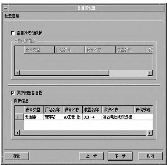
图 4 保护闭锁备自投信息图
