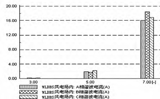
图 7 风电场投运 15 台机组时谐波电流
