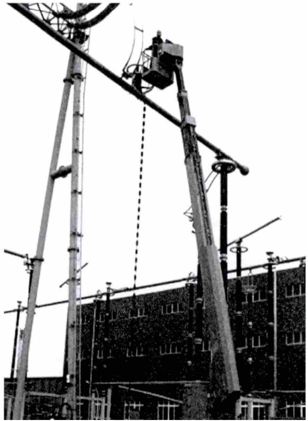
图5 ±500 kV 德阳换流站极线 OTA 试验场景
