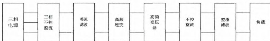
图2 高稳定直流电流源电路框图
