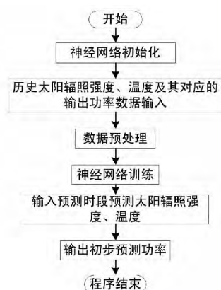
图3 基于BP-ANN的光伏出力初步预测流程图
