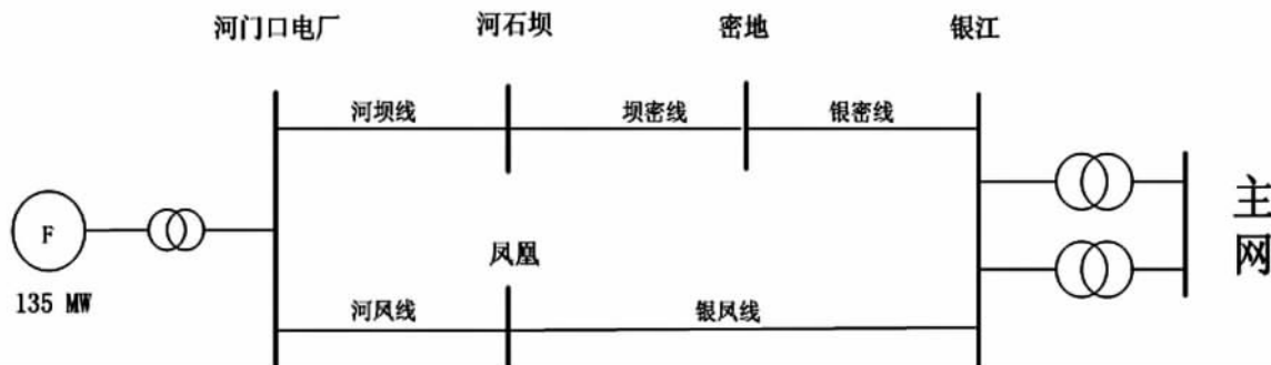
图2 四川某地区部分 110 kV 电网结构图
