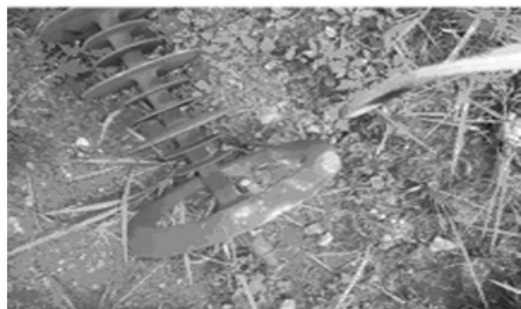
图2 19号塔复合绝缘子均压环放电图
