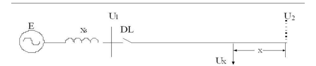
图 1 空载合闸等值电路图
