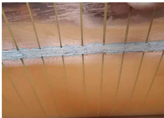
图 14 改进后的铁轭接地屏蔽
