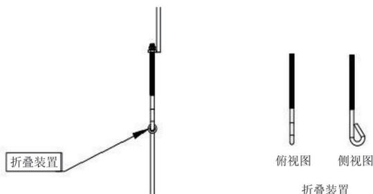
图5 固定架折叠装置
