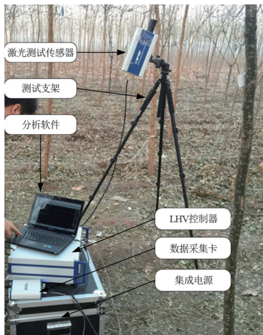
(a) 测试设备安装
