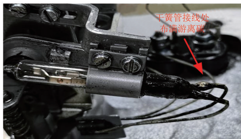
图 2 干簧管接线处游离碳
