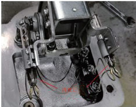
图6 干簧管端部游离碳清理后
